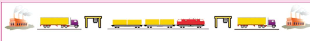
L'**autoroute ferroviaire** (appelée également route roulante) appartient à la catégorie du transport combiné rail-route. Elle se distingue par l'absence de transbordement : le véhicule routier prend place sur le train par « transroulage », sur des wagons à plancher surbaissé. Deux configurations sont possibles :
